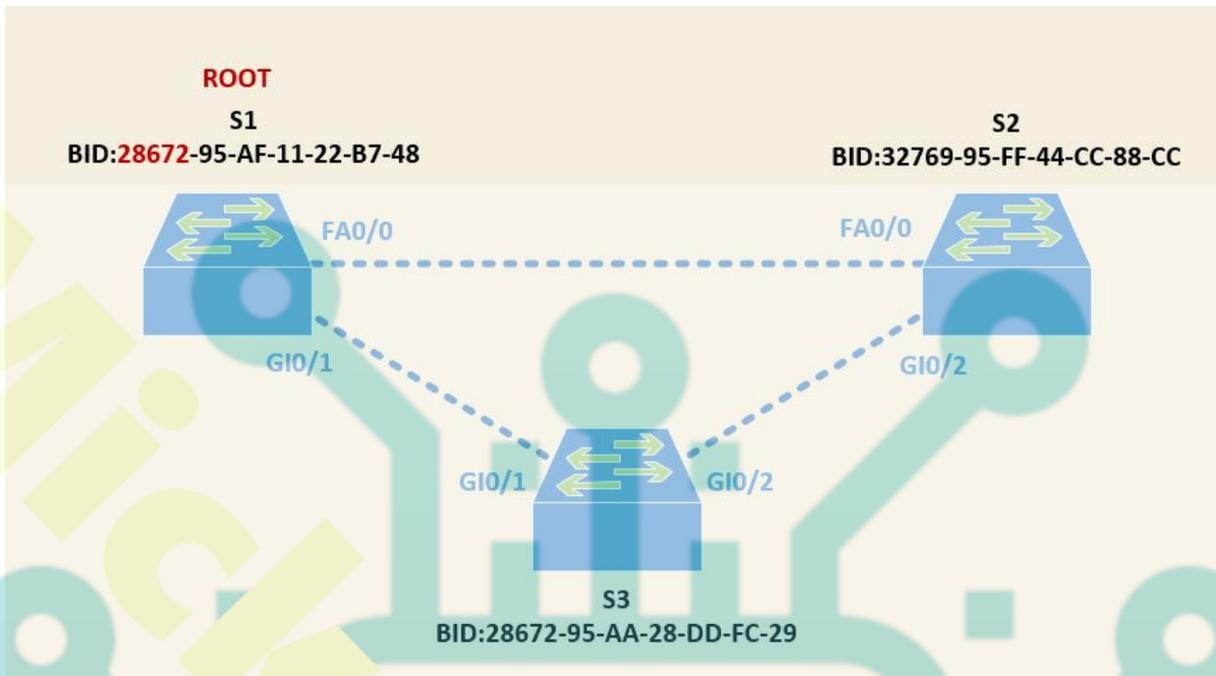
1. A chaque entrée sur une interface, le cost de l'interface est additionné au « Root Path Cost » du BPDU.
